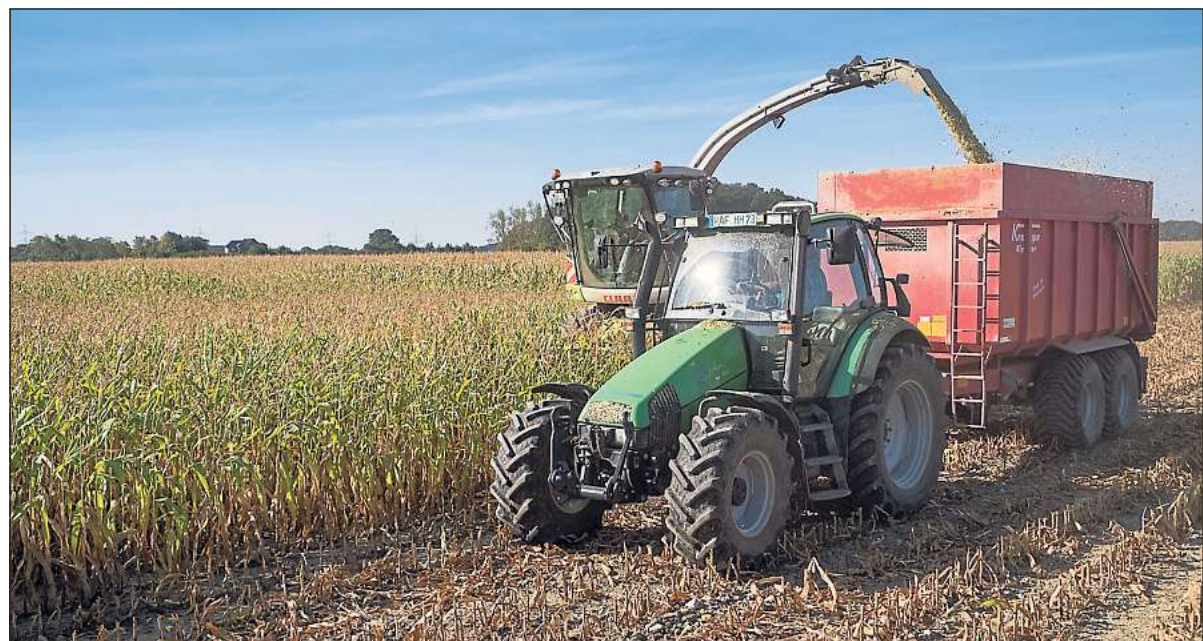
Wichtig ist, dass der Schlepper mit dem Anhänger bei der Maisernte auf dem Hof Liekenbrock in Ostenfelde dicht neben dem Maishäcksler fährt, um die Ernte aufzunehmen. Ist der Hänger vollgeladen, geht es schnellstmöglich zu den Silotürmen auf dem Hof, zu dem die Ladung gebracht wird.
